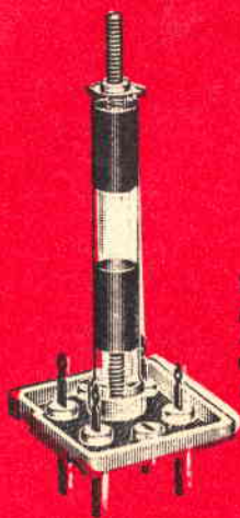
Fig. 3 - Supporto in polistirolo, completo di 1 nucleo ferromagnetico utilizzato per avvolgere la bobina L1.
