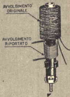
Fig. 5 - Bobina normale usata in televisione e adattata, mediante il secondo avvolgimento, per l'impiego nell'apparato ricevitore-trasmittitore.
